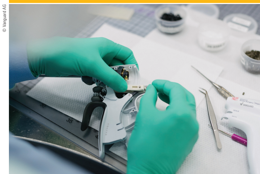
Bild 2: Während des Remanufacturings einer Ultraschallschere
