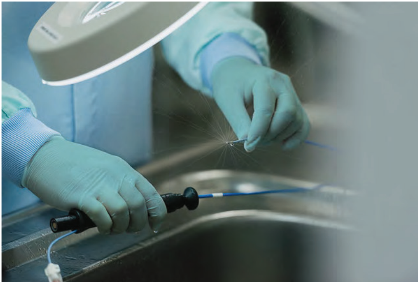
Abb. 2: Prüfung eines Elektrophysiologie-Katheters; © Vanguard AG
